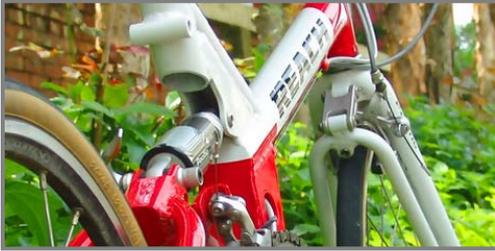
Reach 的後避震器內部使用 PU 避震優力膠，構造簡單、免保養。若出廠預設的軟硬度，感覺避震作動太軟或太硬時。可依本說明著手更換不同硬度的 PU(黃色:軟、紅色:適中、綠色:硬)。
